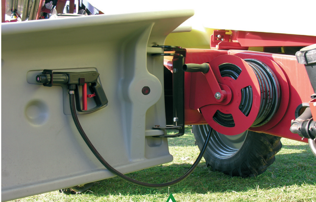
Fot. 2. Zestaw do ciśnieniowego mycia zewnętrznego opryskiwacza
