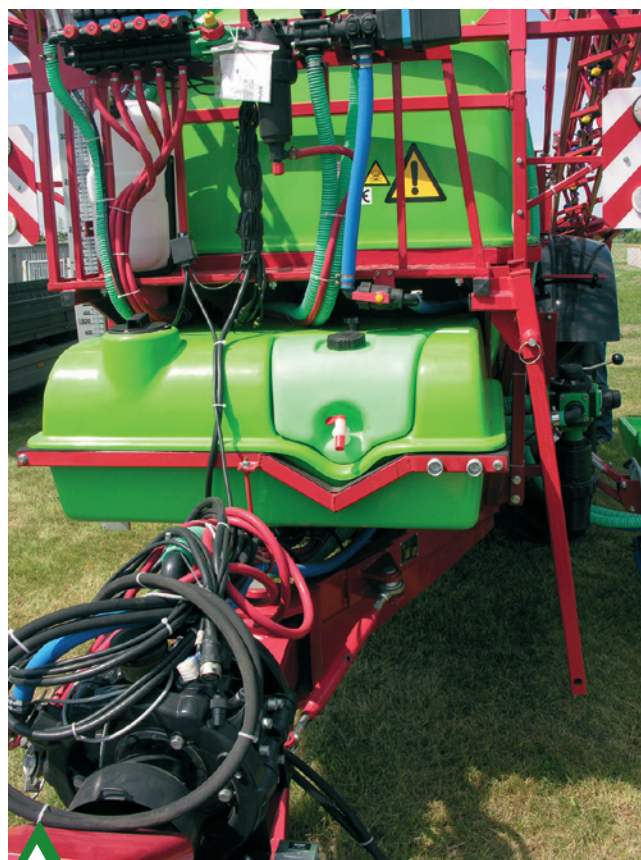
Fot. 1 Dodatkowy zbiornik na wodę do płukania instalacji cieczowej opryskiwacza
