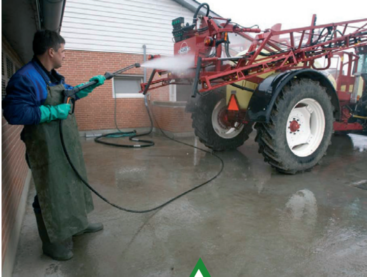
Fot. 3. Zewnętrzne mycie opryskiwacza na nieprzepuszczalnym podłożu z możliwością zbierania skażonej wody
