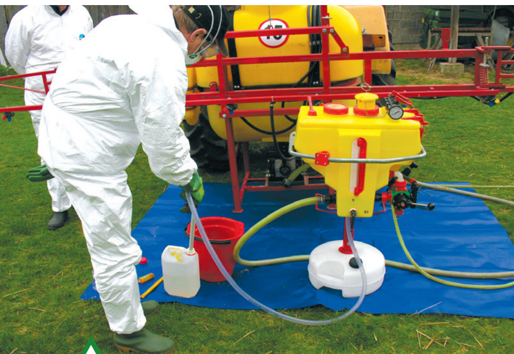
Fot. 3. Rozwadniacz preparatów w wersji urządzenia zewnętrznego, działającego samodzielnie, do wykorzystania w gospodarstwie
