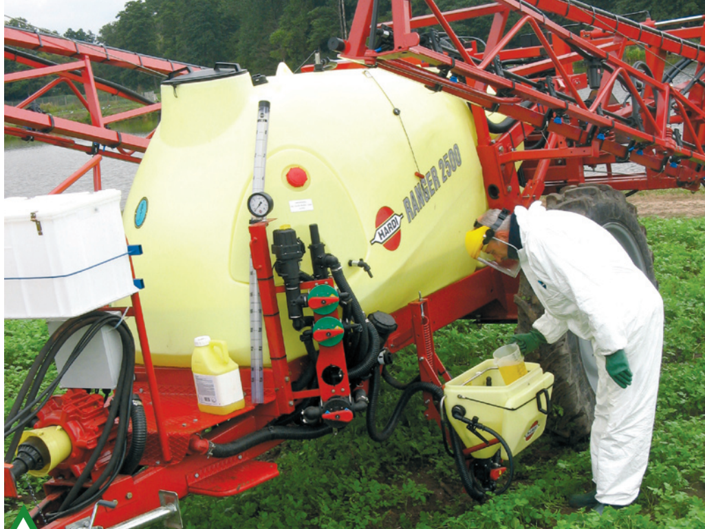
Fot. 2. Rozwadniacz preparatów jako wyposażenie opryskiwacza, umożliwiające bezpieczne sporządzanie cieczy użytkowej na polu
