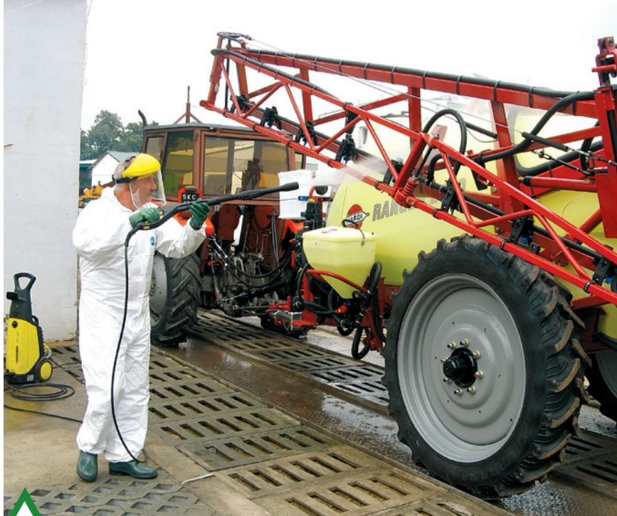
Fot. 4. Mycie na stanowisku biobed jest dopuszczalne tylko pod warunkiem stosowania niewielkiej ilości wody, np. przy użyciu myjki ciśnieniowej
